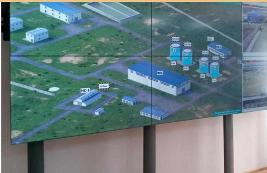
Результаты измерений и аварийная сигнализация бесперебойно поступают в систему ATM SCADA (разработки ООО «АТМ») и используются в построении интерактивной анимированной диспетчерской системы на основе программ моделирования инженерных сетей ZuluGIS (разработки [ООО Политерм](#)).
